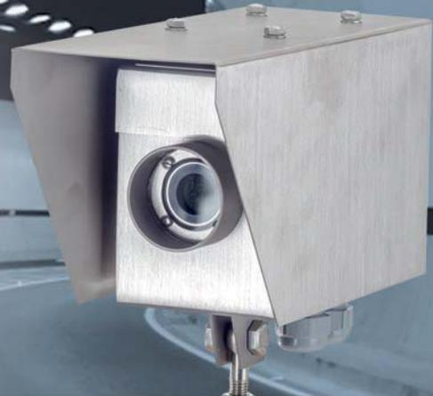
Der Leuchtdichte-Sensor LUCAS erfasst das Messfeld über einen festen Gesichtsfeldwinkel von 20°, der durch ein Diaphragma mit Kaskaden-Apertur gebildet wird. Ein Diopter-Visier dient zum Ausrichten des Sensors. Maskierungen können nicht vorgenommen werden.
