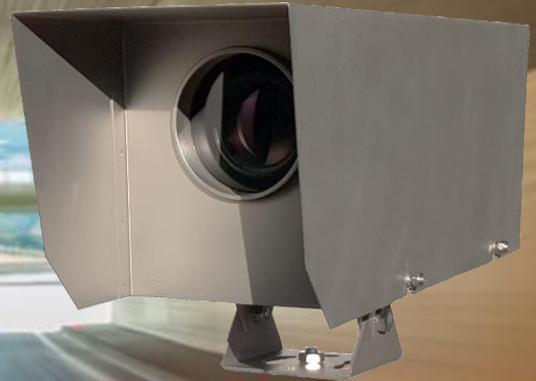
L<sub>20</sub>-Leuchtdichte-Sensoren erfassen – aus dem Abstand der Haltesichtweite – die mittlere Leuchtdichte des Tunnelumfeldes als Sollwert der Lichtregelung.
